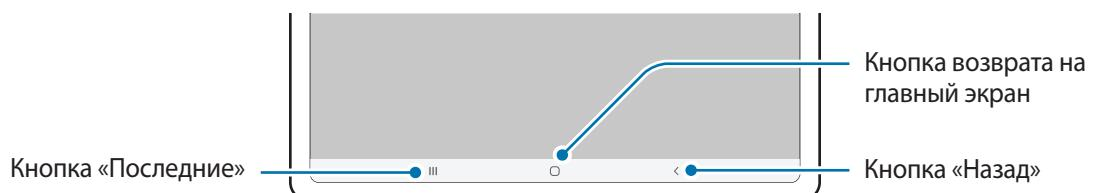
После включения устройства внизу экрана появляются программные кнопки. Дополнительные сведения см. в разделе [Навигационная панель \(программные кнопки\)](#).
