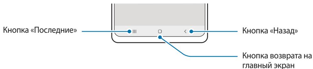
После включения устройства внизу экрана появляются программные кнопки. Дополнительные сведения см. в разделе [Навигационная панель \(программные кнопки\)](#).
